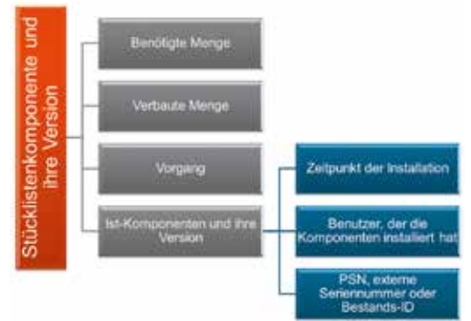
As-Built-Beispiel-Struktur zeigt, wie das Produkt gefertigt wurde.
